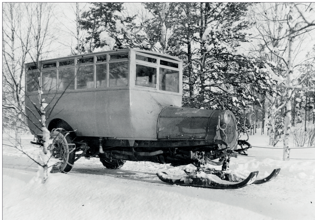
F W Lundholms egenhändigt tillverkade "snöbuss – postdiligens", en ombyggd lastbil tillverkad i Lycksele omkring 1919–1920. Foto: Postmuseums arkiv.
