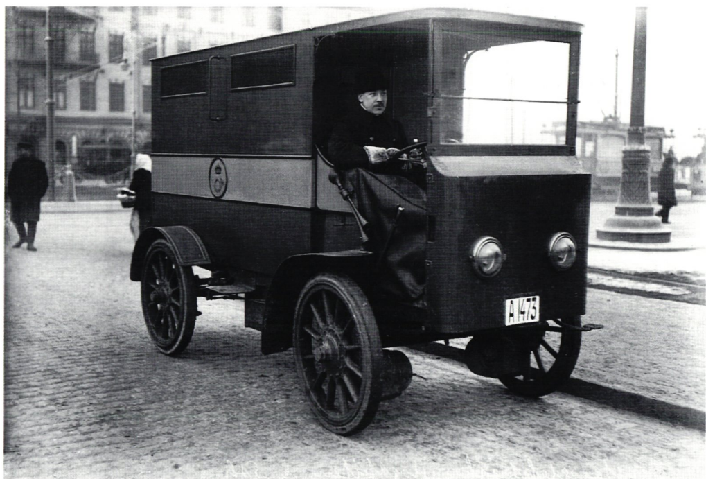
Elektromobilen i Stockholm var tillverkad av Norddeutsche Automobil & Motoren Aktiengesellschaft. Bilen var tung och de då primitiva batterierna gjorde att körsträckan blev kort. Observera elmotorerna innanför framhjulen. Foto Postmuseum.
