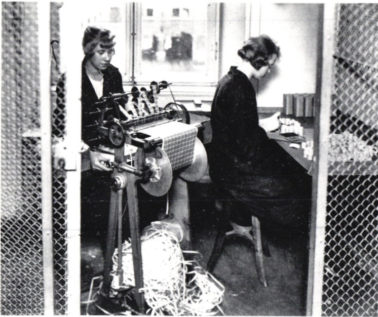
I spolningmaskinen skars frimärksbanan i längdriktningen och banden rullades upp till rullar med 100 eller 500 frimärken. Paketering av rullarna skedde i omedelbar anslutning till spolningen.
