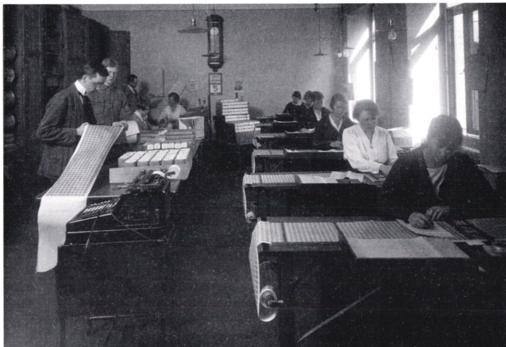
Vid kontrollborden granskade personalen kvalitén på tryck och perforering. I samma lokal skötte kontrollräkning av frimärkena.
