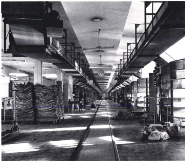
32. Stora tidningsläggarsalen, södra flygel. I taket rembanor, från tidningsintaget till specialsorteringarna. I golvet rembanor för transport av färdiga kollin. Klockan är 13.50 och värsta ruschen är över. Foto 1956
