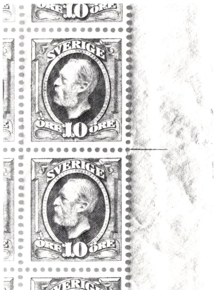
Vid perforeringen nålades arken upp i en ram genom passningsstreck i de vertikala sidorna.
