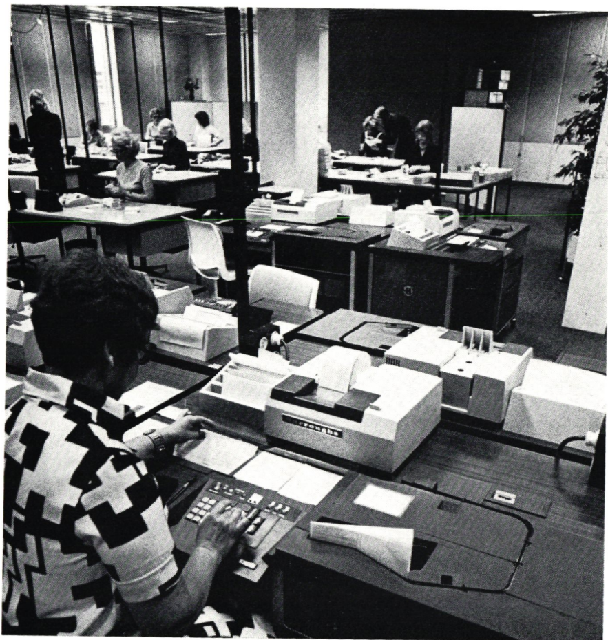
I speciella kodningsmaskiner förbereds betalningsuppdragen för behandlingen i datorer för optisk klartextläsning.
