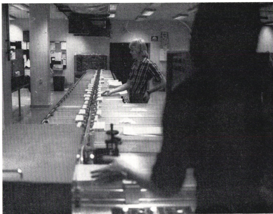
En stor del av den avgående posten sorteras helt maskinellt i denna för Postgirot specialkonstruerade sorteringsmaskin.
